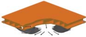
Querschnitt durch ein Load Module™ Aero-Caster® zeigt den Luftstrom während des Aufblasens.
