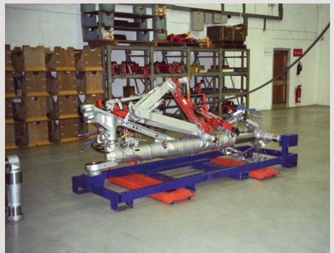
Fahrgestell wird einfach bewegt in der Montagestrasse
